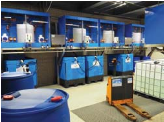
Zusammen mit Diversey lieferte ALPMA auch die CIP-Linien für die neue UO-Anlage (Foto: mi)
