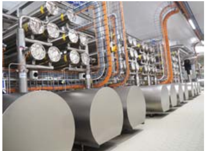
Ein UO-Prozess erfordert einen erheblichen Druck, der in Gerkesklooster von einer Reihe großer Pumpen von Grundfos und Alfa Laval aufgebaut wird (Foto: mi)
